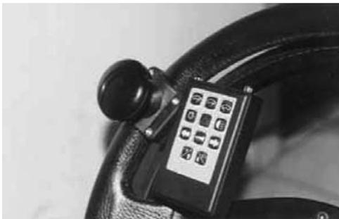
Une télécommande regroupant l'ensemble des fonctions est fixée sur le volant et jumelée avec une boule de manœuvre permettant au conducteur de contrôler la direction et les fonctions du véhicule d'une seule main.
